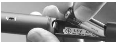
Abb. 1 und 2 – Einlegen der Batterie
