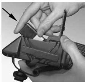
Abb. 1 bis 3 – Einsetzen der Batterie
