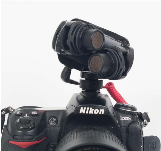
Das Mikrofon setzte sich aus zwei elastisch gelagerten Kleinmembran-Kondensator-Kapseln in X/Y-Anordnung zusammen.
