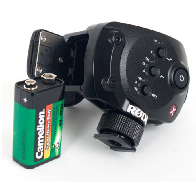
Als Energielieferant dient entweder eine 9 Volt-Block Batterie (bei direkter Verbindung zur DSLR-Kamera) oder Phantomspannung (bei einer Verbindung zu einem Vorverstärker über die Mini-XLR-Buchsen).
