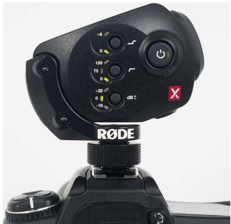
Wohl ausgestattet: Das Stereo VideoMic X besitzt ein zweistufiges Hochpassfilter, einem Höhen-Boost sowie eine anpassbare Eingangsempfindlichkeit.
