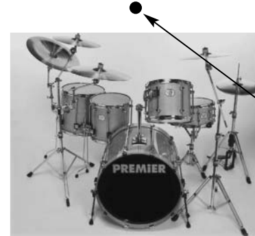
Abb. 6 – Overhead-Aufnahme Das NT1-A weist nach unten auf das Schlagzeug
